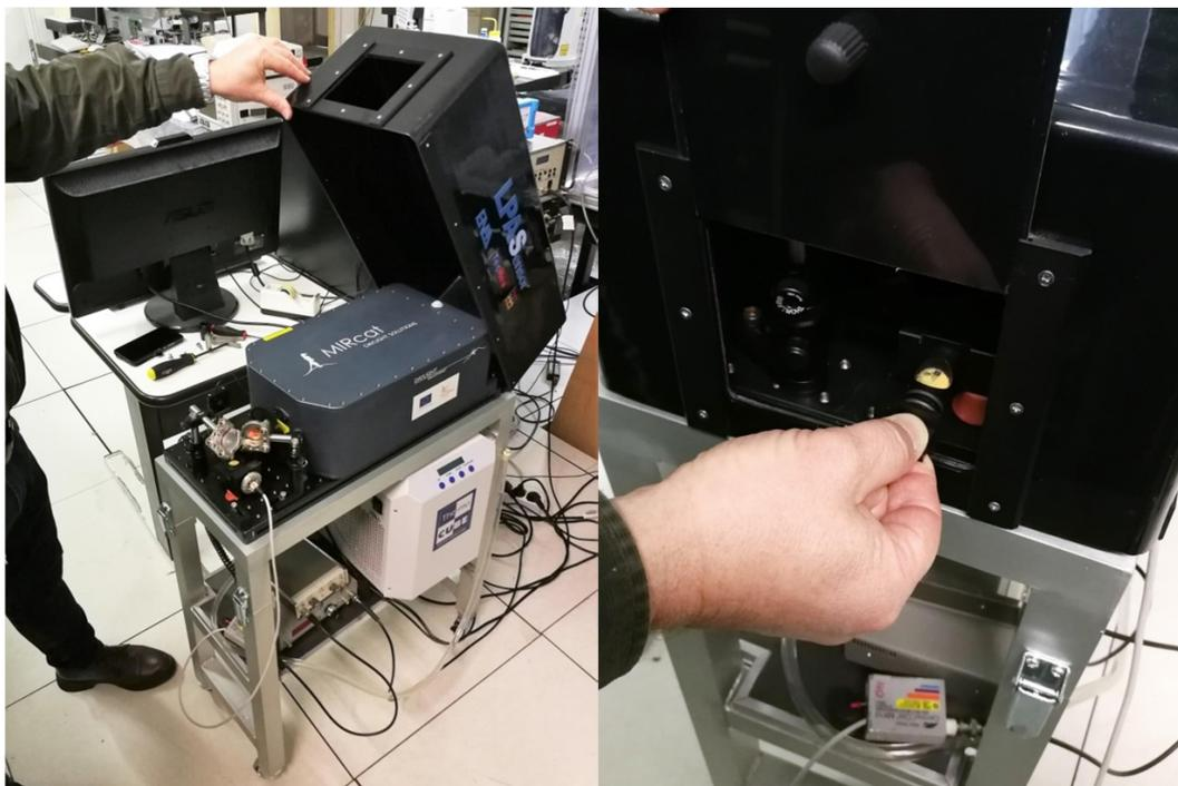
*Fig. 1. Prototipo per linea di produzione montato su un carrello con zampe ripiegabili, trasportabile in due valigie, con il coperchio sollevato (sinistra); nella parte superiore si notano il laser (box blu navy) e i componenti elettroottici, nella parte inferiore si notano il chiller (box grigio chiaro) e i componenti elettronici. Inserimento di un campione nella cella attraverso una finestra laterale praticata sul coperchio (destra).*
