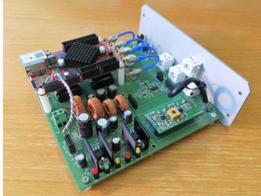
Fig. 3. Foto della scheda madre che racchiude i componenti elettronici del prototipo per analisi speditive. La scheda sarà montata nella valigetta sotto il laser.
