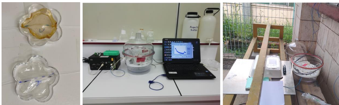
Figura 1. Sinistra: prototipi di sensori di umidità in alloggiamenti rigidi; centro: set-up per la taratura dei sensori con il metodo delle soluzioni sature di sali; destra: set-up per la validazione dei sensori in ambiente reale.
