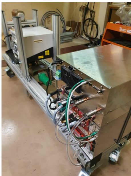
Figura 6. Vista dal retro del prototipo che mostra i collegamenti relativi al modulatore SCANDINOVA.
